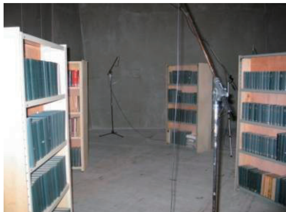
写真-1 残響室本棚設置の様子 （条件ii本棚（本入）4架をランダム配置）
