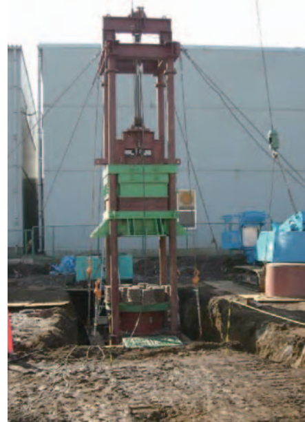
写真-3 急速載荷試験の状況
