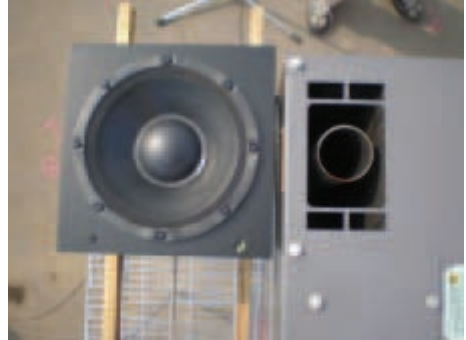
図 - 7 2 次音源スピーカおよびエラーマイク設置状況 (実験 2)
