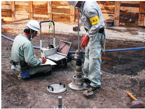
写真-2 急速平板载荷試験実施状況
