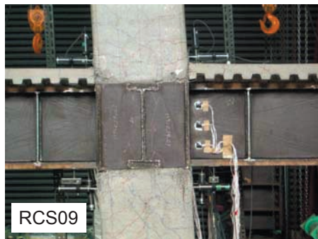
写真-2 破壊状況 (シリーズ2 No.6,9)
