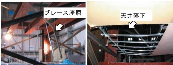
写真-4 衝突による落下実験の被害状況(B-340x)
