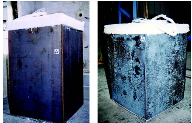
写真 - 1 加熱試験前後の試験体状況 (鋼板)
