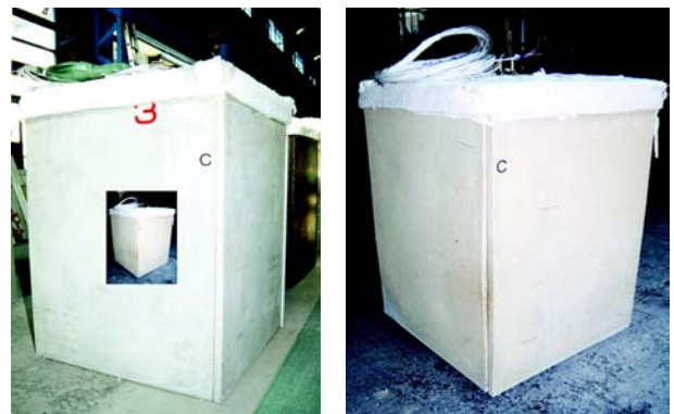
写真 - 3 加熱試験前後の試験体状況 (PCa 板)
