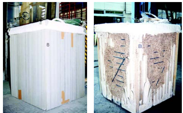
写真 - 2 加熱試験前後の試験体状況 (押出成形板)
