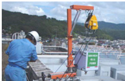
福島県内のビル屋上で測定ロボットシステムをセット（全パーツを工具レスで組立）
