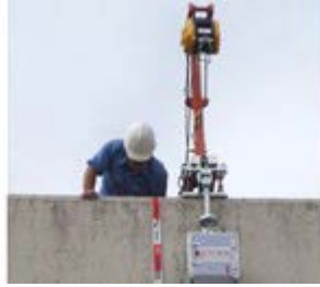
電動昇降し、自動測定する「さー兵衛」
