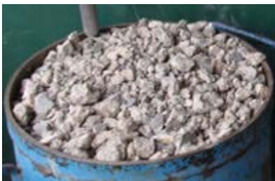
(左) 汚染されたコンクリート(骨材に破碎) (右) 骨材利用したコンクリートの試験ピース
