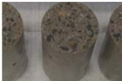
(左) 汚染されたコンクリート(骨材に破碎) (右) 骨材利用したコンクリートの試験ピース
