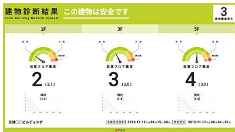
建物震度表示、建物健全性表示画面
