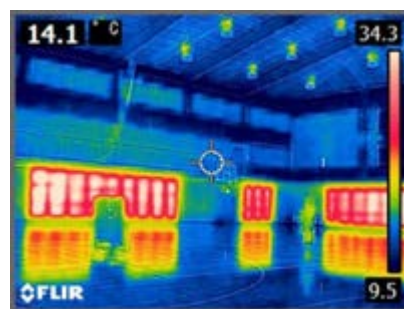
施工後の赤外線カメラによる温度計測状況
