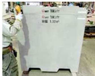
RFIDタグを埋め込んだTOMコンテナ
