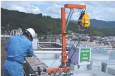
福島県内のビル屋上で測定ロボットシステムをセット(全パーツを工具レスで組立)
