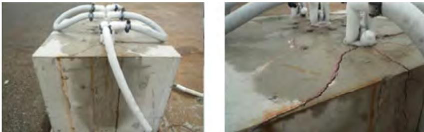
凍結膨張圧実験での破壊状況
