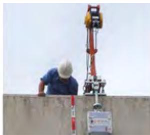
福島県内のビル屋上で測定ロボットシ 電動昇降し、自動測定する「さー兵衛」システムをセット(全パーツを工具レスで組立)
