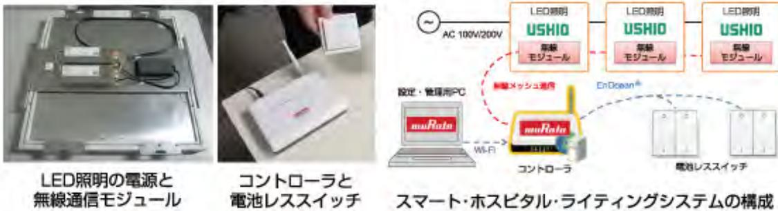
無線通信制御を用いたLED照明システム
