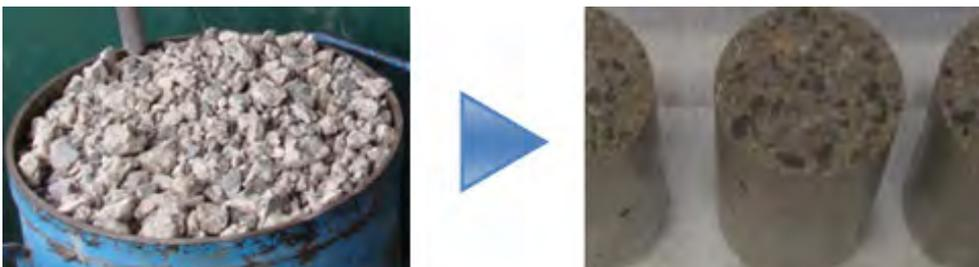
(左) 汚染されたコンクリート(骨材に破碎) (右) 骨材利用したコンクリートの試験ピース
