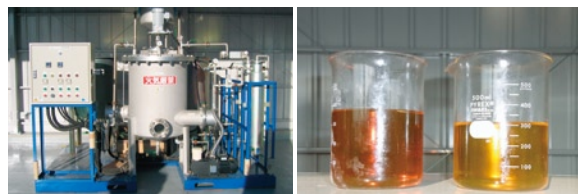
BDF製造装置 廃食用油(左)とBDF(右)
