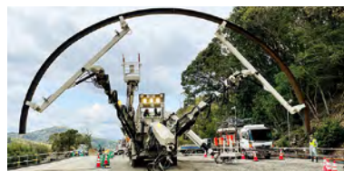
山岳トンネル切羽無人化施工システム Optiss®
