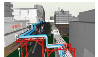
BIMモデルを用いたインフラ配管の盛替え検討
