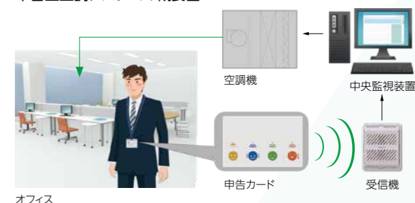
申告型空調システムの概要図
