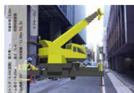
近接建物がある場所に設置した3Dモデル(クレーン)の一例
