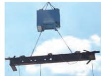
3 ジャイロ機構と画像認識技術を活用した吊荷旋回制御装置「ジャイアン」
