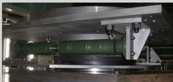
オイルダンパー付き弾性すべり支承の構成
