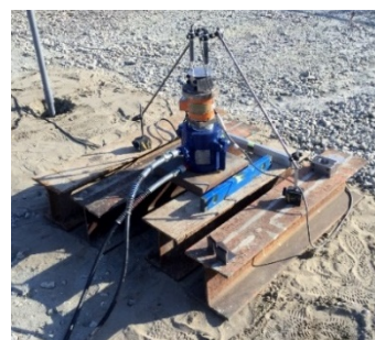
写真-3 地山パッカ引抜き試験状況
