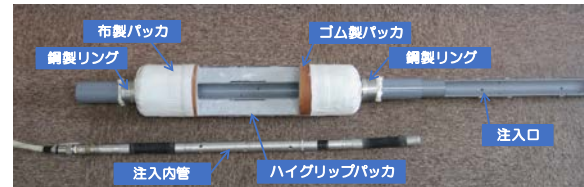
写真-1 本工法のパッカ（ハイグリップパッカ）構造
