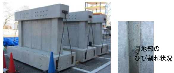
図-7 ひび割れ誘発試験状況
