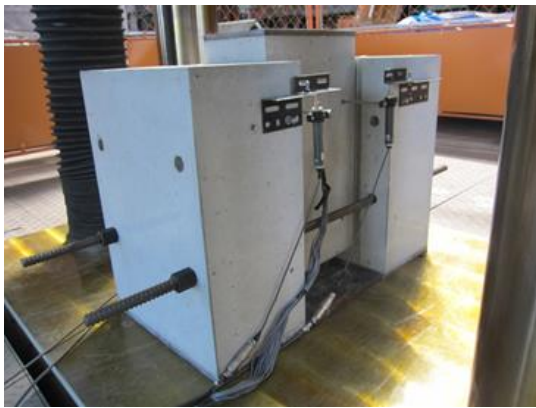
図-13 押し抜き要素試験体
