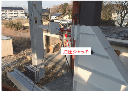
写真-3 支持部材剛性測定状況（最上段）
