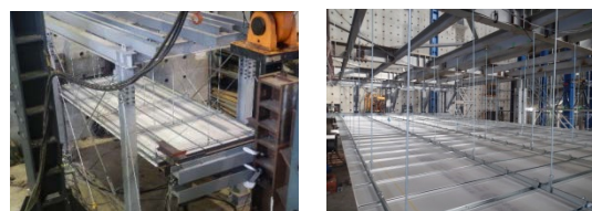
写真-2 実験状況（面内圧縮実験）
