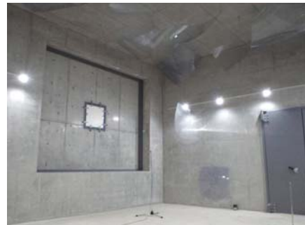
写真-3 残響室側の開口
