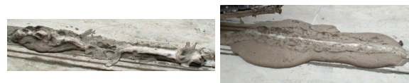
界面活性剤濃度 0.4% 水量 1.1ℓ/m 2 切断能率 7.66m 2 /h 界面活性剤濃度 0.4% 水量 2.1ℓ/m 2 切断能率 8.89m 2 /h
