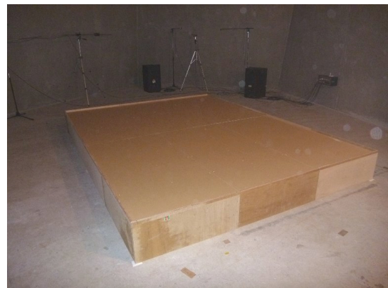
写真-2 吸音率測定状況
