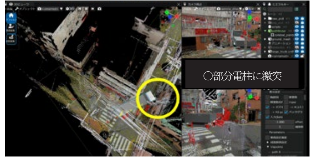
図 13 10tトラックによる輸送状況の確認
