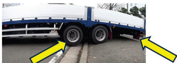
写真2 タイヤ非接地および車両後端の路面近接状態
