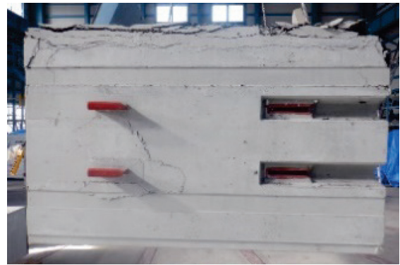
写真 8 終局時のひび割れ発生状況
