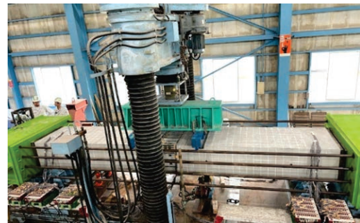
図2 軸力を導入したセグメント継手曲げ試験
