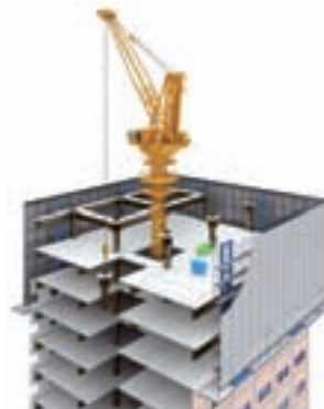
TO-ZERO工法模式図
