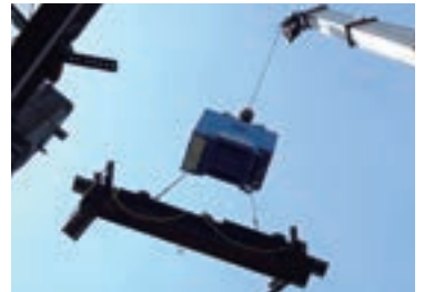
クレーンの吊荷旋回制御装置「ジャイアン®」
