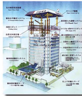
戸田式自動化施工システム ～ルーフロボ～
