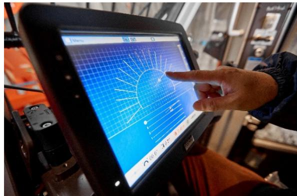
写真5 打設位置マシンガイダンス表示
