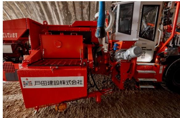
写真3 モルタル供給装置
