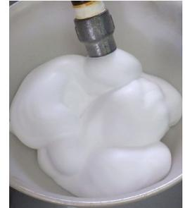
※1 気泡シールド工法：切羽またはチャンバー内に気泡を注入しながら掘進する工法。掘削土の流動性を高めるほか、チャンバー内の掘削土の付着を防止できるため、切羽の安定を保持しながらスムーズな掘進ができ、多くのシールド工事で採用されている。
