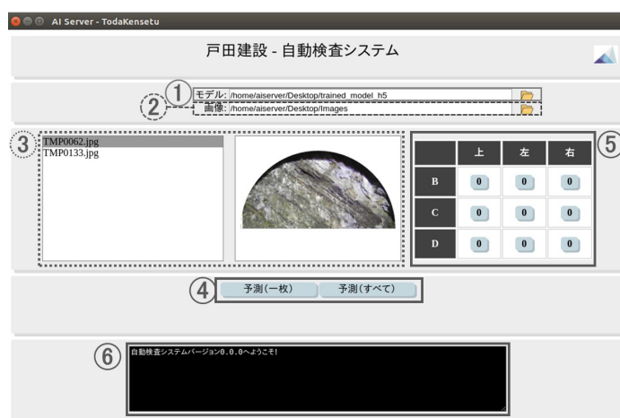
図-1 AI切羽評価支援システムのパソコン操作画面(判定システム)
