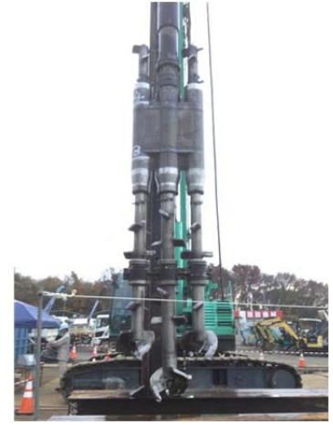
写真-1 固化工程専用機 写真-2 固化工程専用機先端部
