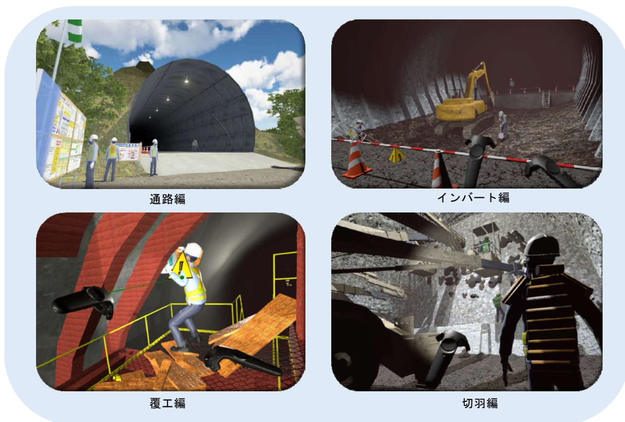
図-1 主な作業場面で臨場感ある安全学習ができる「バーチャルNATM」(画面例)
