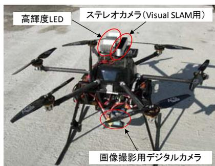
写真-1 使用したドローン(UAV)
