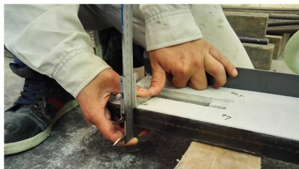
図3 分割型拘束材における充填材表面の精度管理
