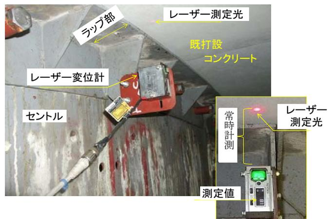
写真-1 レーザー変位計による計測状況
