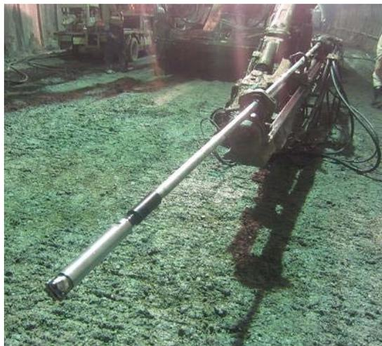
写真2 ドリルジャンボに装着された拡縮径ビット
