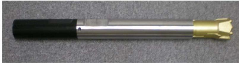
写真1 小口径拡縮径ビット
