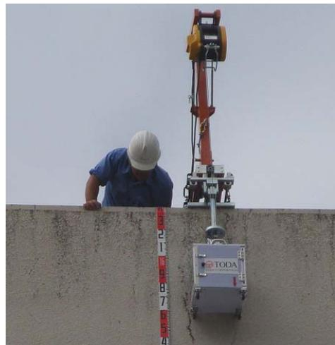
写真2 電動昇降し、自動測定する「さー兵衛」
