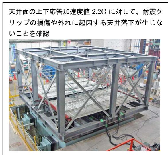
写真3 天井面応答加速度値2.2Gでの振動実験
