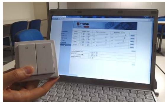
写真3 無線通信による照明シーン設定
