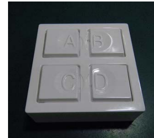
写真2 圧電発電方式に変更 (左: 2回路用、右: 4回路用)
