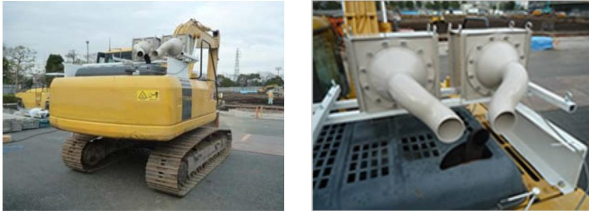
写真2 掘削機に設置したTANC（タンク）
