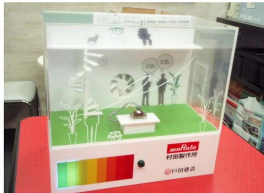
写真5 CO<sub>2</sub>濃度センサーを組み込んだシステム模型
