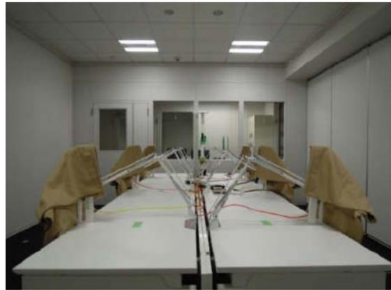
写真4 模擬人体発熱（電気掛毛布）で実験
