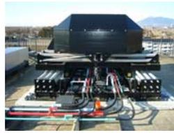
写真1 加振装置
