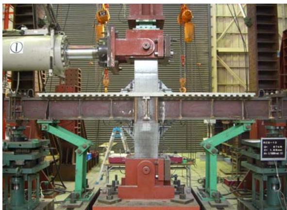
写真1 性能確認構造実験（柱  $F_c 100 \text{ N/mm}^2$ ）
