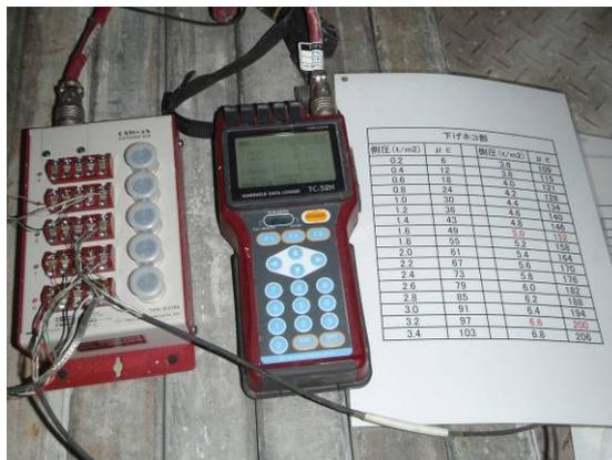
写真2 打設時側圧確認
