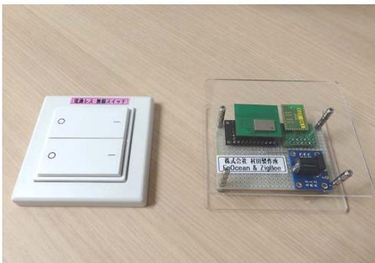
写真1 自己発電式の無線照明制御スイッチ
