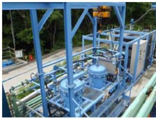
写真2 TSフィルターろ過装置
